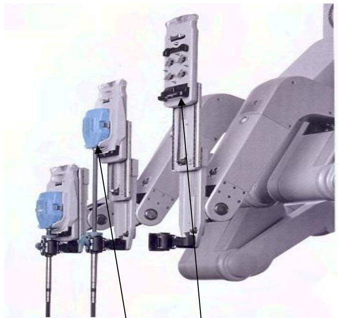
Encaixe dos EndoWrist nos braços mecânicos
